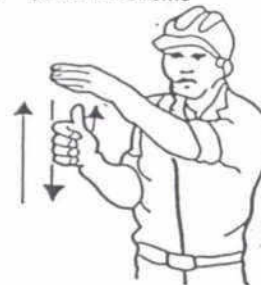
4 Levantar el aguilón o pluma lentamente
