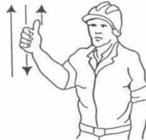
4 Levantar el aguilón o pluma lentamente
